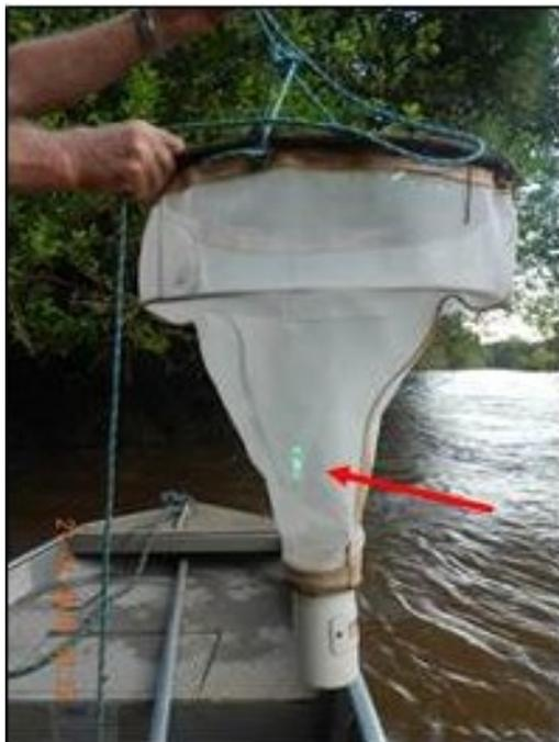
**Figura 9.** Modelo utilizado de armadilha luminosa. A seta vermelha indica a posição da lâmpada de LED, fixada no interior da armadilha.
