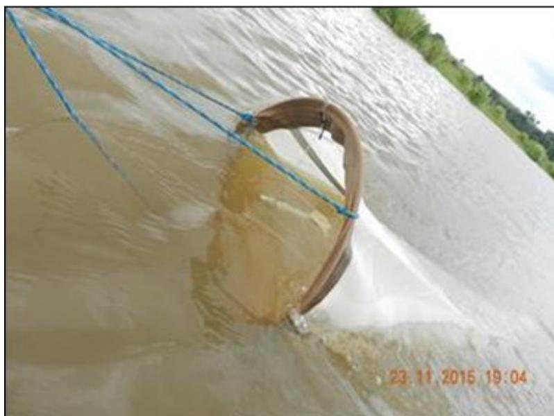
**Figura 11.** Modelo de rede pelágica de arrasto com fluxômetro acoplado.
