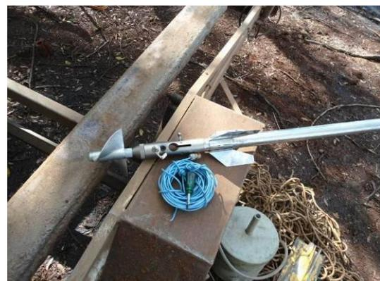
**Foto 1-59** Molinete hidrométrico para medição de vazão (24/02/2015).
