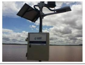
**Foto 1-27** Estação telemétrica do barramento (15/12/2015).
